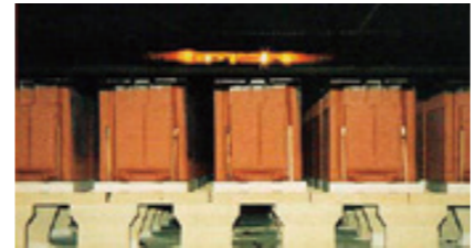
図3. 瓦を立てて焼く生産ライン
